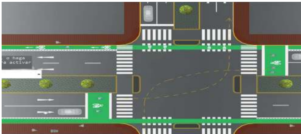
Gráfico N° 4.5: Modelo de diseño de intersección semaforizada con zonas de espera especial para bicicletas y viraje a la izquierda.
