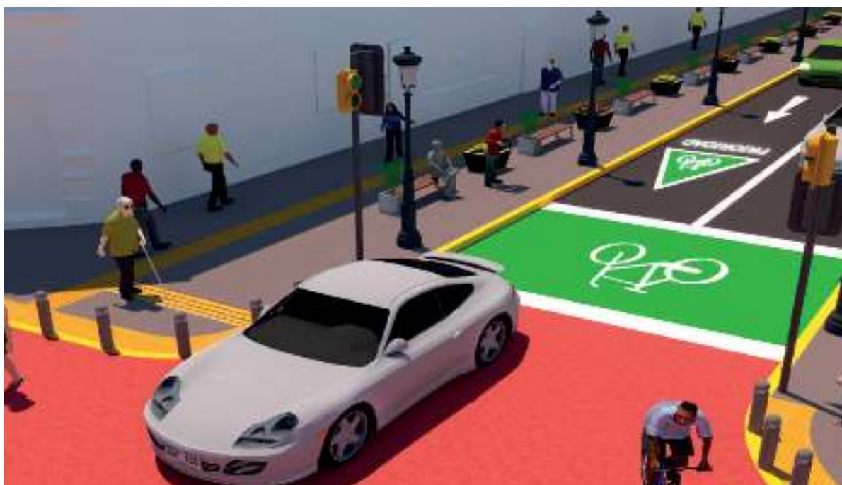
Gráfico N° 4.16: Ejemplo de intervenciones con semaforización peatonal.
