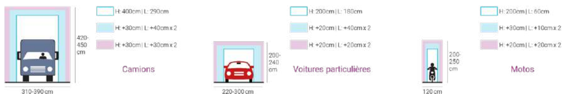
Figure 25 : Dimensions de base pour les modes individuels motorisés
