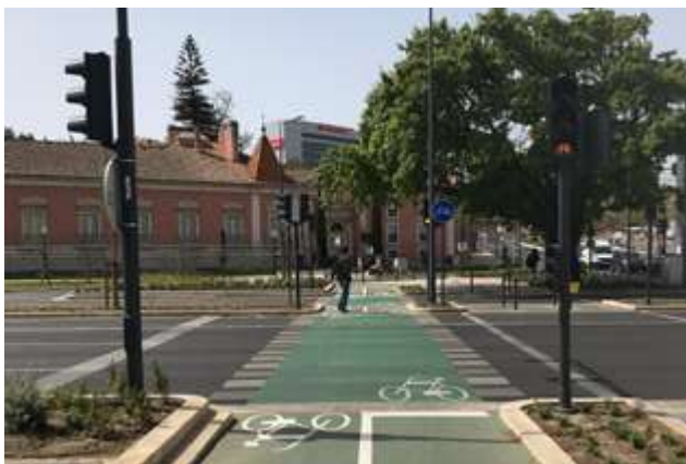
↑ Lisboa, Portugal. Ciclovía bidireccional segregada en Plaza de España, con clara señalización vertical y horizontal en el cruce. Imagen: Shanna Lucchesi.
