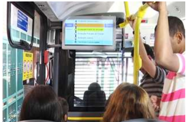
↑ Recife, Brasil. Aplicación de datos de la tecnología embarcada en los ómnibus para monitoreo de la flota en centro de control operacional e información en tiempo real a usuarios en app vía smartphones. Imágenes: https://cittamobi.com.br/
