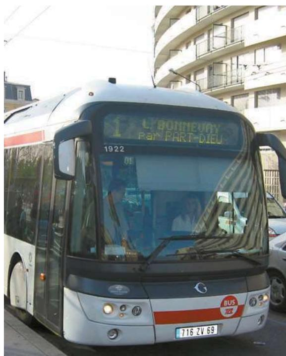
comme le tramway. Il est alimenté par deux lignes de contact aériennes appelées aussi bifilaires. Le système de captage du courant est issu de celui utilisé par les tramways. Le trolleybus moderne, relooké, à plancher bas et plus confortable, refait son apparition depuis peu, comme par exemple à Lyon.
