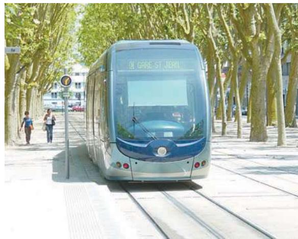
Sa capacité oscille entre 2 000 et 8 000 pphpd (quatre passagers par m<sup>2</sup>), selon la longueur des véhicules, variant de 20 à 60 mètres pour une vitesse commerciale entre 18 et 25 km/h en moyenne.
