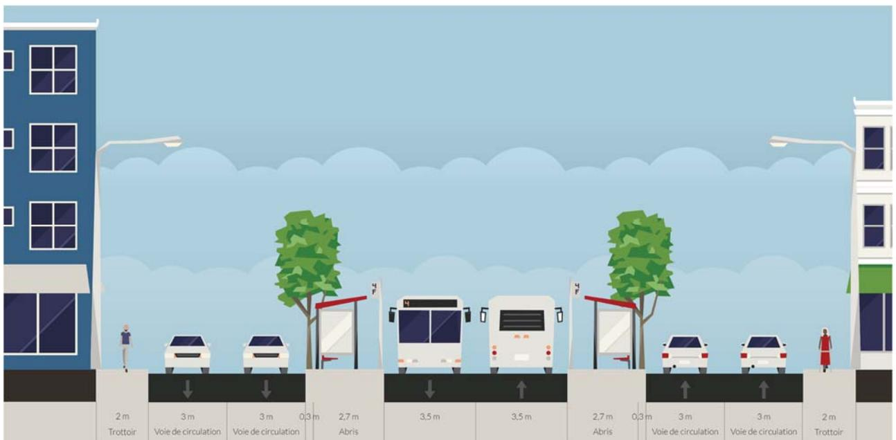
Figure 37 : Coupe-type d'une station de TCSP (TRANSYAOUNDÉ) en axial sur le corridor Nord-Sud
