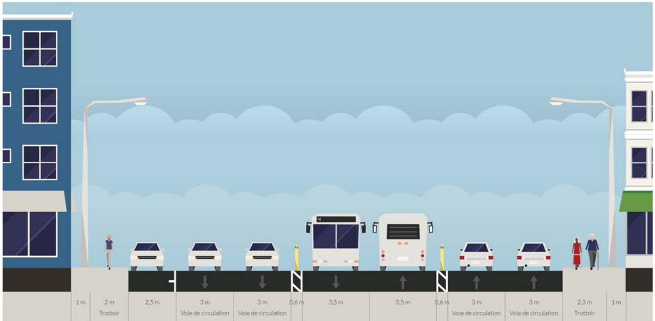
Figure 36 : Coupe-type de l'insertion d'un TCSP (TRANSYAOUNDÉ) sur le corridor Nord-Sud avec ségrégation des voies bus
